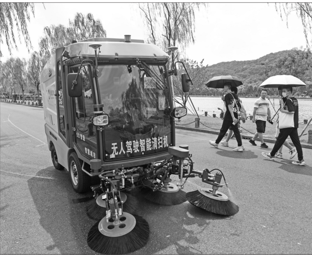
近日,基于5G传输、L4级别无人驾驶、视觉识别等技术的智能清扫机在浙江杭州西湖景区投入使用。该清扫机配备多个摄像头和雷达,可自主进行清扫作业,并对游客进行避让。图为8月10日,5G无人驾驶智能清扫机在西湖白堤作业。
