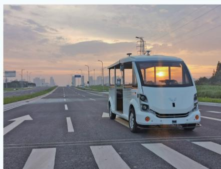
驾驶过程中,车辆能够精准识别车辆正前方40米以内、高×宽在500×300毫米以上的障碍物、车辆、行人等,并通过域控制器(ACU)对感知传感器采集的数据进行综合处理,并作出减速或刹车等动作。车辆平直道路行驶最高车速为每小时25公里,且保证目标车速控制均匀平稳。
