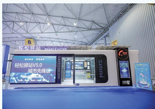
模块化移动智慧厕所通过物联网平台、新型无臭、环保节能等技术,为国内外市政、景区、商超、大型商演活动等场景提供一站式智慧便民设施。该产品改变了传统移动厕所使用空间狭小、功能单一、美观度不高的状况,具备防疫消毒、臭味监控、粪污无害化处理、智慧管理、新空间新经济培育等功能。模块化移动智慧厕所搭载企业自有的粪污处理技术,可做到对粪污一体化处理,处理后的污水达到三级排放标准,可直接排放至下水管道或者二次利用灌溉周边植物。
